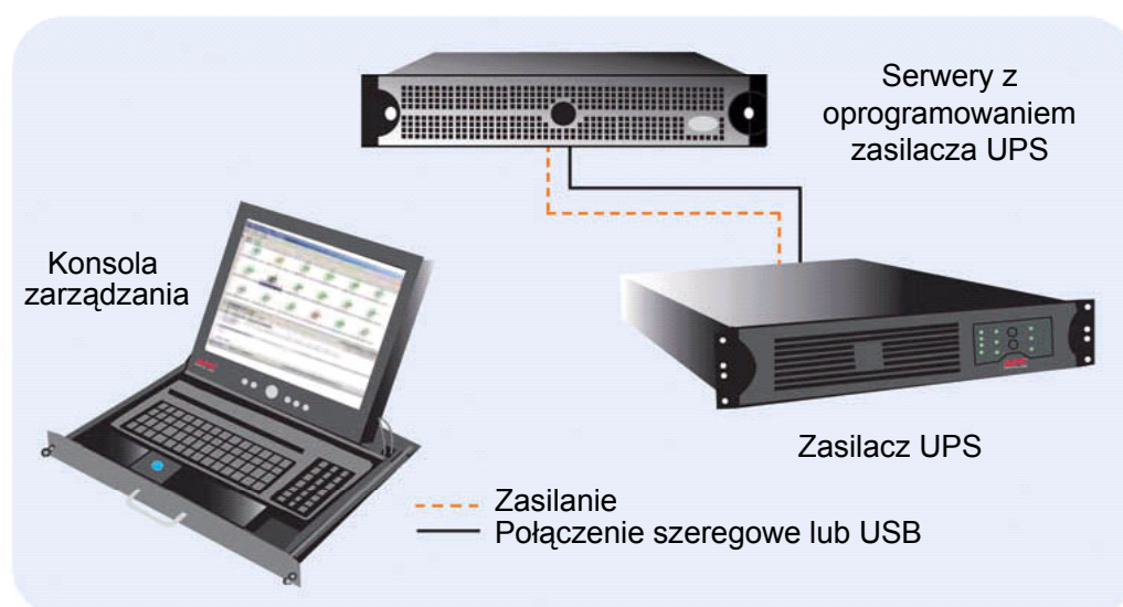
Rysunek 1 – Ochrona pojedynczego komputera za pomocą pojedynczego zasilacza UPS
