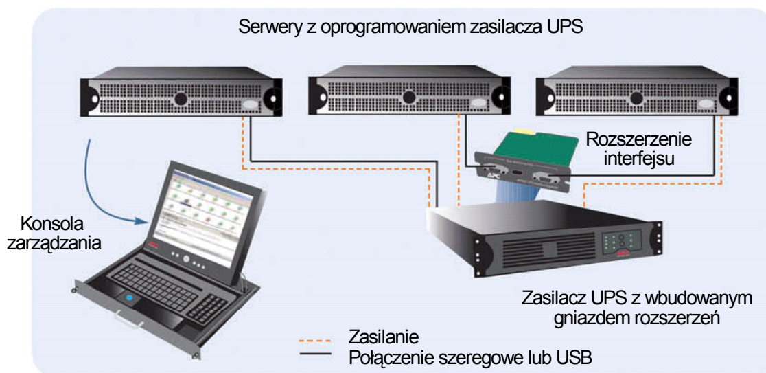
Rysunek 2 – Ochrona dwóch do trzech komputerów za pomocą pojedynczego zasilacza UPS
